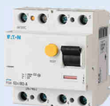
Interrupteur différentiel 4P 63A 30mA type AC
